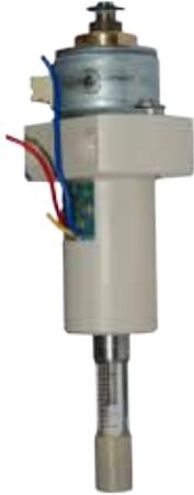
Diese Spritzenpumpen sind mit einem 2-Phasen-Bipolar-Schrittmotor ausgestattet und bestehen durch eine geringe Bauform von nur 26 x 42 x 120 mm bei Kapazitäten von 100 µl bis 1000 µl.
